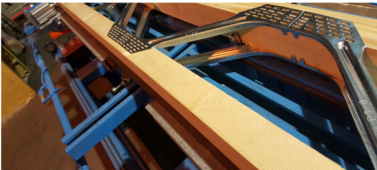
Posi-Joist-bjälklag kombinerat med ett traditionellt ramverk.
