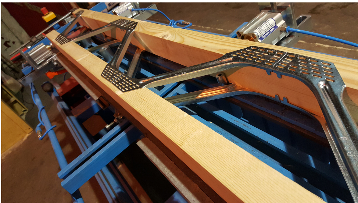
Posi-balkar produceras i fabrik hos Posi-producenter och levereras projektanpassade till byggplats.
